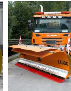
Les photos montrent une lame à neige avec équipement spécial
