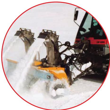
Die Lateral-Schneefrässchleudern haben zwei hydraulisch dreh- und neigbare Auswurfkammine, welche jeweils über 4 Klappen verfügen. Diese können sowohl einzeln als auch parallel gesteuert werden. Die beiden, seitlich gelagerten Fräshaspeln sind über automatische Abschaltkupplungen gesichert.
