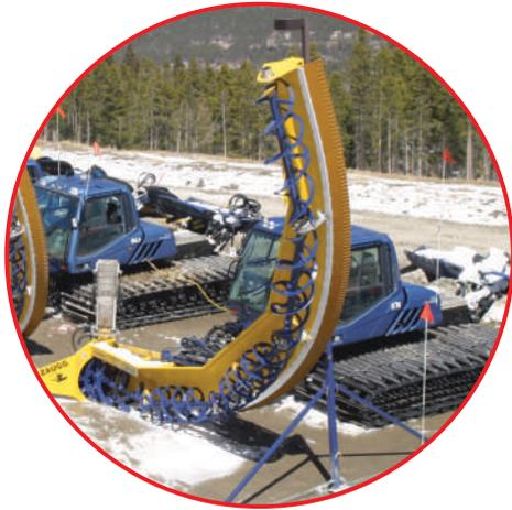
Die Maschine wird an Pistenfahrzeuge angebaut und von der fahrzeugeigenen Hydraulik angetrieben. Die Fräshaspeln sind radial angeordnet und verfügen über die Halfpipe-spezifische Form. Der abgetragene Schnee wird durch das Schleuderrad über den Kamin aus der Pipe geworfen. Die am Gehäuse befestigten Finisher streichen nach dem Fräsen die Schneeoberfläche glatt.
