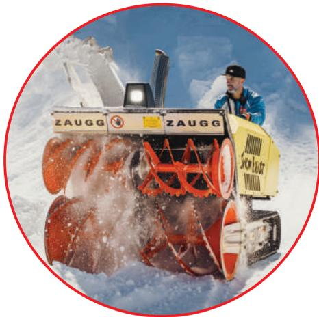
Das Snowbeast ist eine handgeführte Raupen-Schneefrässchleuder mit hoher Leistungsdichte. Dank den übereinander angeordneten Fräshaspeln verzeichnet das Snowbeast eine Räumhöhe bis zu 120 cm. Mittels einer ergonomischen 2-Hebel-Joystick-Steuerung kann die Maschine einfach bedient werden.
